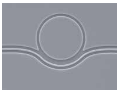
Канал волновода соединен с кольцевым резонатором. Ширина волновода - около 320 нм, диаметр резонатора - 3 мкм. Длина волны экспонирующего лазера - 405 нм. Дизайн создан с [1].
